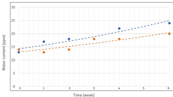
Teneur en eau pour le chloroforme stabilisé à l'amylène, réalisée avec la méthode Karl Fischer sur 6 semaines. Jusqu'à 28 prélèvements dans la même bouteille à l'aide d'une aiguille de calibre 18.
